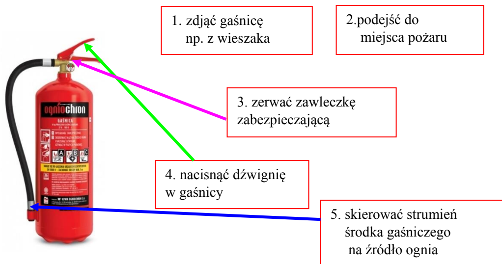
Rysunek 1 Opis sposobu uruchomienia podręcznego sprzętu gaśniczego
